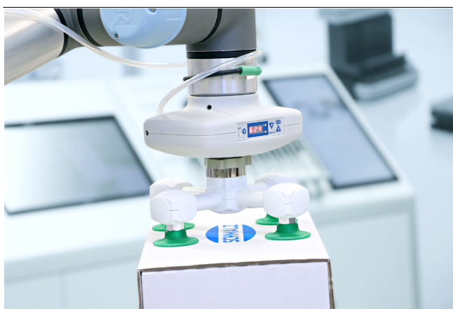
Générateur de vide pneumatique RECB lors de la manipulation de cartons
